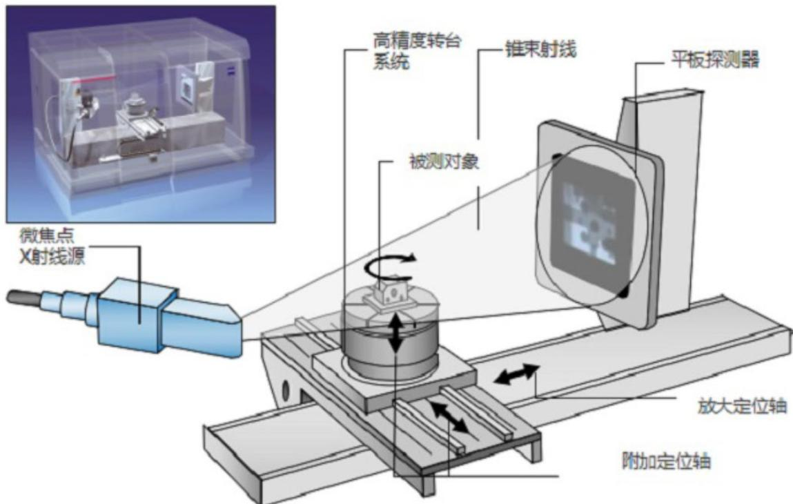
图 9.1 工业 CT 机设备结构示意图
